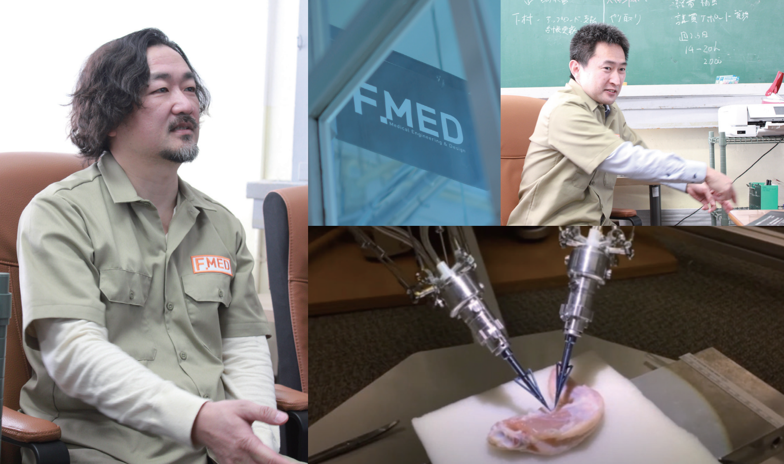
鶏肉を使ったマイクロサージャリー支援用ロボットの吻合の様子(出所:F.MED You Tubeチャンネル)
